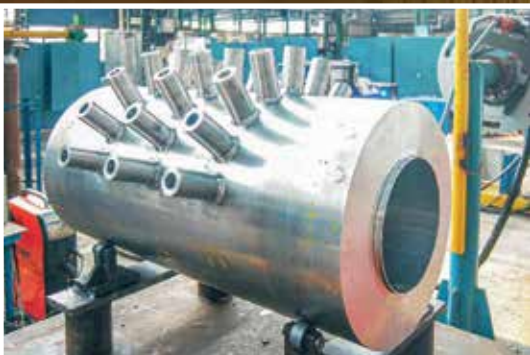
उन्नत उच्च तापमान सामग्री के साथ एयूएससीबॉयलरों हेतु मॉक-अप थिक वॉल सुपरहीटर हेडर
