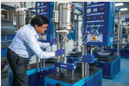
एयूएससीपावर प्लांट अनुप्रयोगों के लिए उन्नत सामग्री की क्रीप टेस्टिंग
