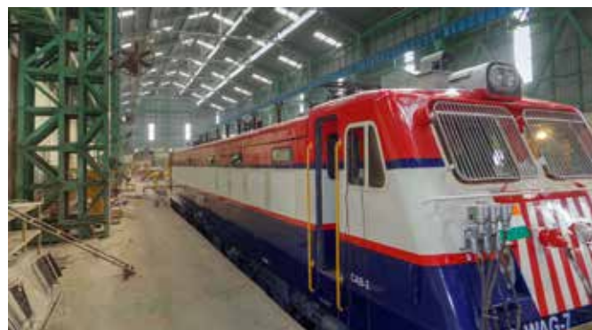
रीजनरेटिव ब्रेकिंग प्रणाली सहित WAG-7 5000 एचपी लोकोमोटिव बीएचईएल झांसी में उत्पादन के अंतिम चरणों में
