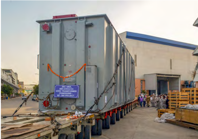
800 केवी क्लास सिंगल केस एचवीडीसी कनवर्टर ट्रांसफार्मर के लिए 295-1 एमवीए, 800 केवी, एचवीडीसी ट्रांसफार्मर की एचईपी भोपाल से रवानगी
